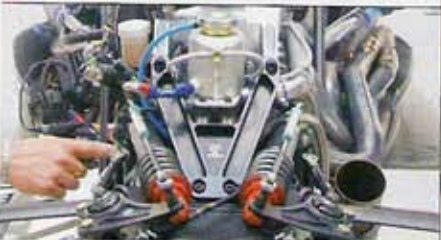
Standfester Kraftmeier: Der 2,0-Liter-Motor basiert auf einem Honda-Serienaggregat. Er muss nur alle 5000 Kilometer überarbeitet werden. Unten: Aufhängung mit einheitlichen Koni-Dämpfern und Federn von Eibach
