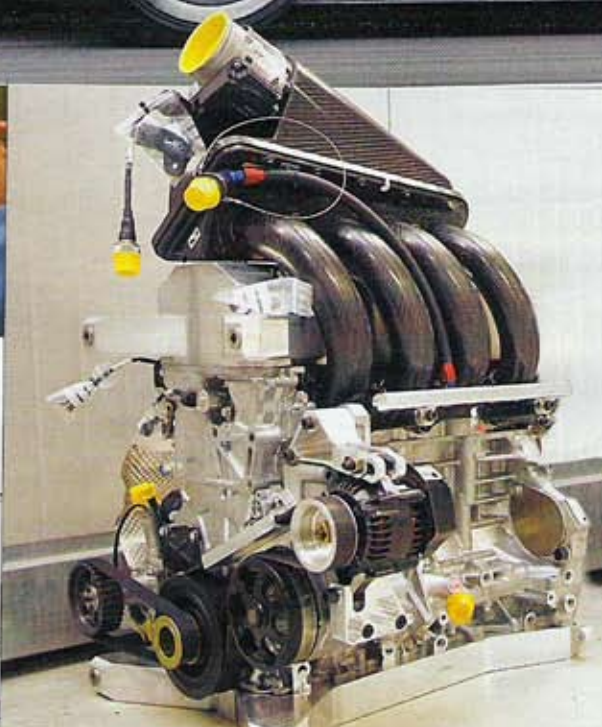
Standfester Kraftmeier: Der 2,0-Liter-Motor basiert auf einem Honda-Serienaggregat. Er muss nur alle 5000 Kilometer überarbeitet werden. Unten: Aufhängung mit einheitlichen Koni-Dämpfern und Federn von Eibach
